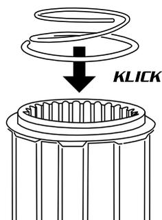
**STELLEN SIE SICHER, DASS DIE FEDER IM FREILAUFKÖRPER EINRASTET.**
