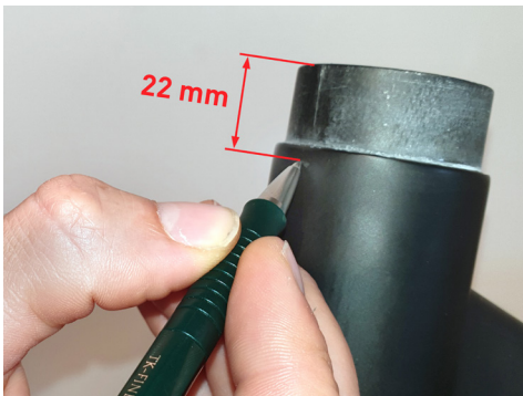
Abb.: Markieren des Bohrlochs
