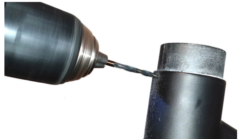
Abb.: Bohren des Lochs für die Stromversorgung
